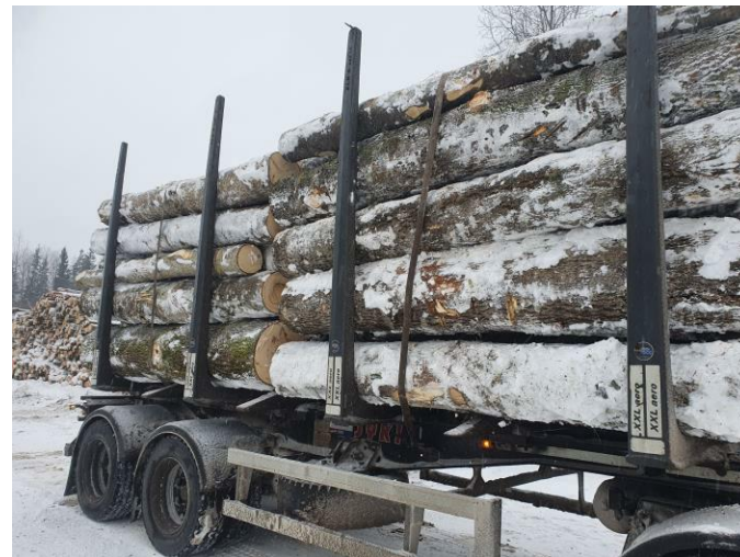
45.att. Kok vedējautomašīnas piekabes kravas nostiprināšana.
