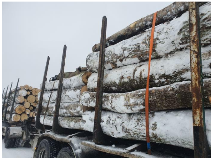
44.att. Kok vedējautomašīnas kravas nostiprināšana.
